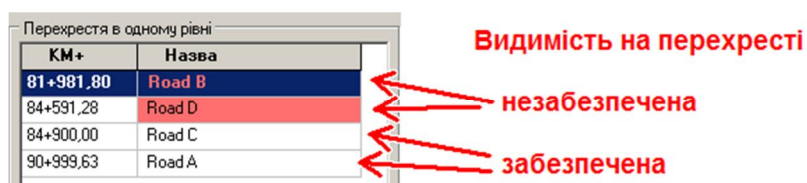
Рисунок 9.22 – Приклад відображення видимості на перехресті
