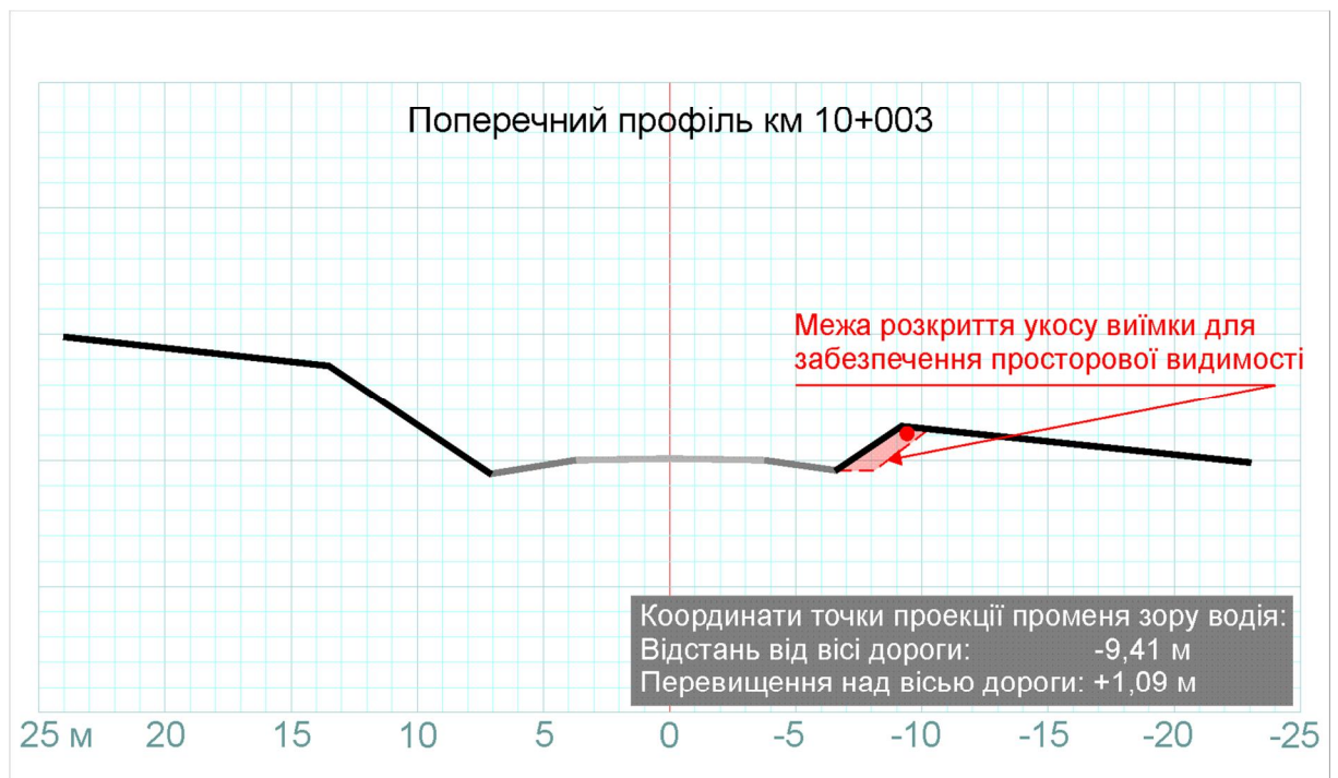
Рисунок 6.6 – Приклад проєкції точки зору водія на площину поперечного перерізу дороги
